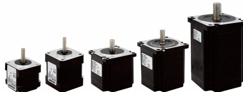
步进电机是一种将电脉冲信号转为角位移或线位移的开环控制精密驱动元件, 它与其相配套的驱动器共同构成一套步进电机系统, 给电机加一个脉冲信号, 电机就相应转过一个步距角。在非超载的情况下, 只要控制驱动器发出的脉冲频率与脉冲数, 就能准确地控制电机的转速与停止的位置, 而不受负载变化的影响, 加上步进电机只有周期性位置误差而无累积误差等运动特点, 在控制电机领域, 与伺服电机、无刷直流电机相比, 步进电机是一种精度高、控制简单、成本低廉的驱动方案。
